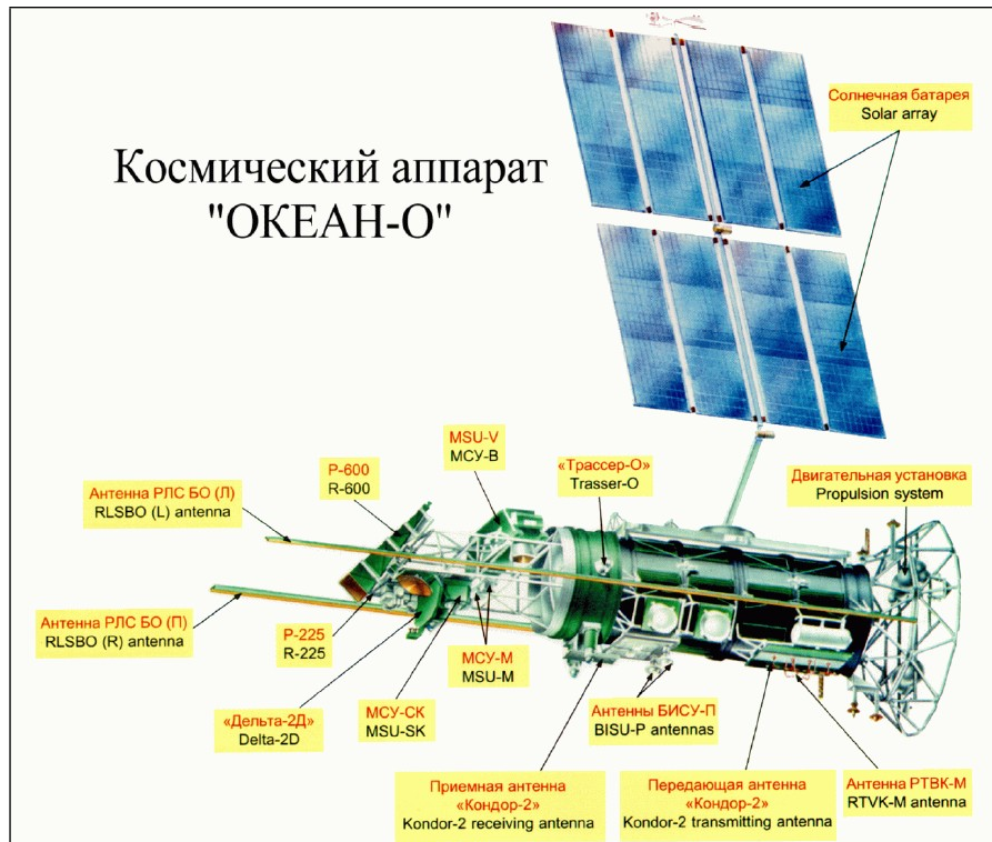
Fig. 4.7.1 – Scheme of Okean-O-1.
